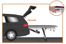
右側にある赤いハンドルを引き、少し持ち上げながら押し、トストレッチャーの前脚が車両内に積載され、後ろ脚がバンパーに届くまで押します。
