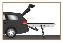
ストレッチャーを少し持ち上げて後脚 が開き完全に固定されるようにしま す。その後、ハンドルを放します。
