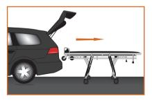
ストレッチャーの前脚の車輪が完全に出るまで引きます。前脚が完全に開き、固定されていることを確認してから、ロールインホイールも霊柩車の外に来るようにします。
